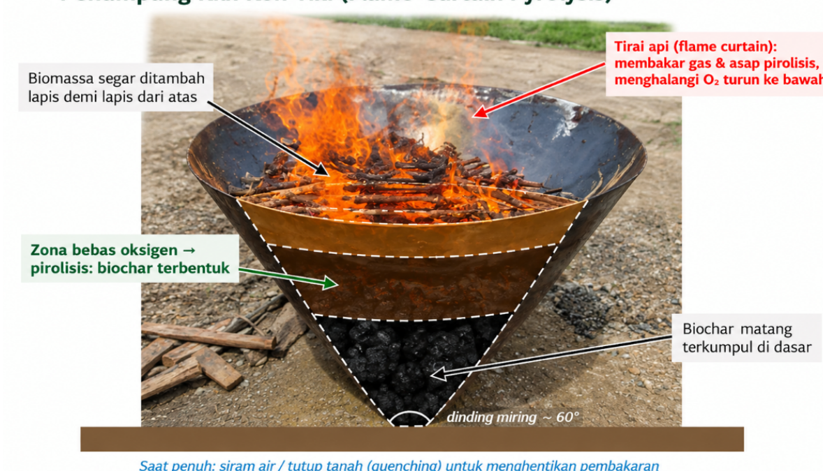
Gambar 4.3 Penampang tungku Kon-Tiki. Tirai api di permukaan membakar asap sekaligus melindungi biochar di bawahnya dari oksigen.
