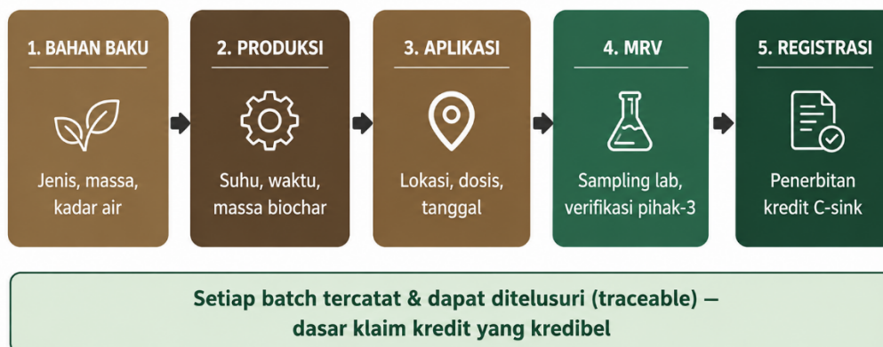
Gambar 7.1 Alur sistem dMRV: dari pencatatan bahan baku, produksi, dan uji mutu, hingga aplikasi ke lahan dan verifikasi pihak ketiga.
